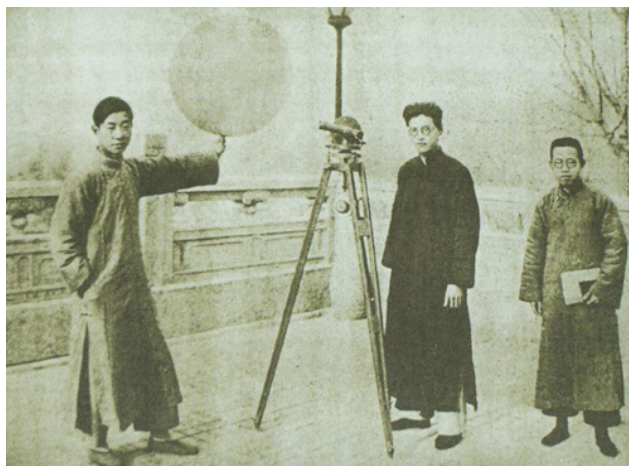
图3 从1930年1月开始，竺可桢组织气象研究所进行高空气球探测试验，图为北极阁气象台施放高空测风气球的场景
