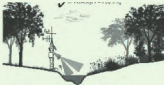
雷达测量径流量示意图
