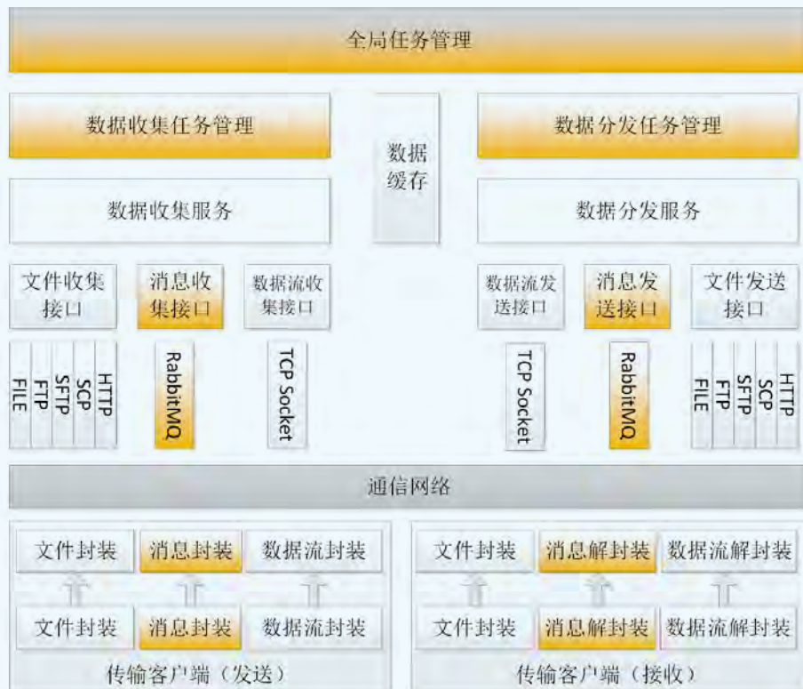
图1 消息队列在CTS2系统架构中的应用
