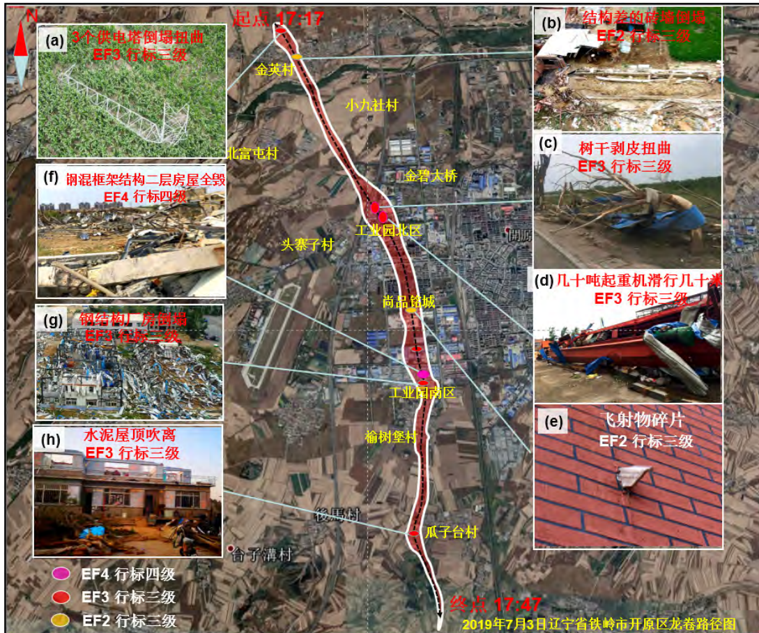
图4 2019年7月3日辽宁省铁岭市开原区龙卷路径图 (黑色虚线为龙卷路径, 红色阴影为破坏范围, 不同颜色椭圆表示不同强度等级)
