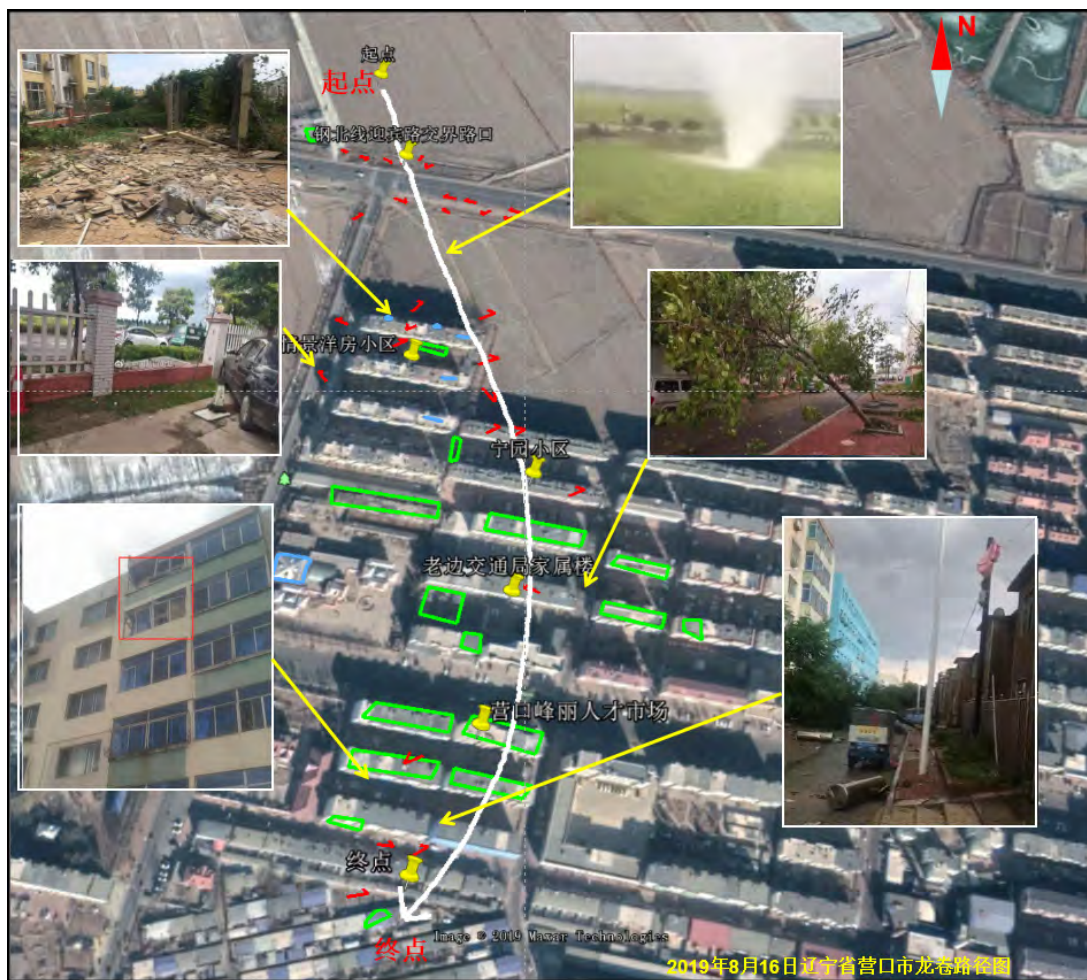
图5 2019年8月16日辽宁省营口市龙卷路径图（白色箭头为龙卷路径，绿色方框为破坏范围，红色箭头为灾情指示物倒伏方向）
