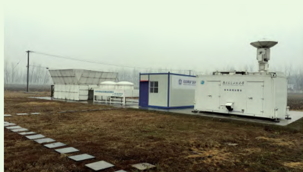
获取了大气柱气溶胶、水汽、温度、风速、风向的5条廓线
