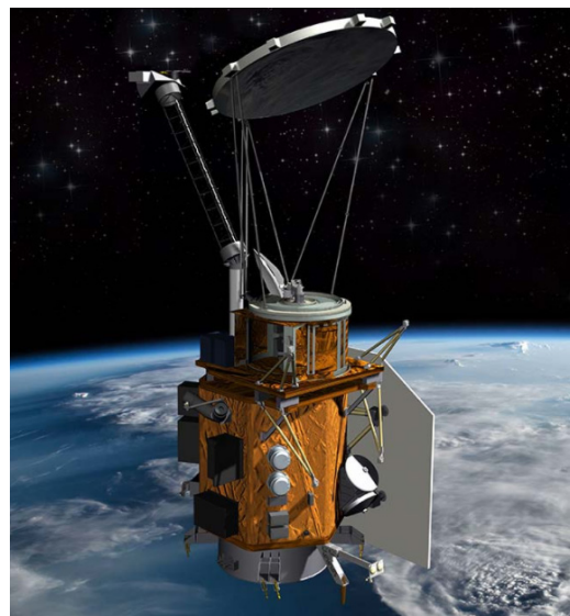
图5 美国下一代国防气象卫星WSF-M概念图, 卫星包括一个被动微波成像辐射计和高能带电粒子传感器
