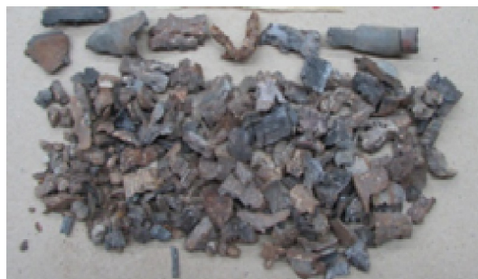
图1 某型37高炮人影弹丸在一次静爆试验中的破片(试验用弹数:5发)
