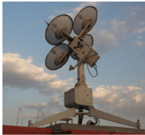
图11 L波段二次测风雷达 Fig. 11 L-band secondary wind radar
